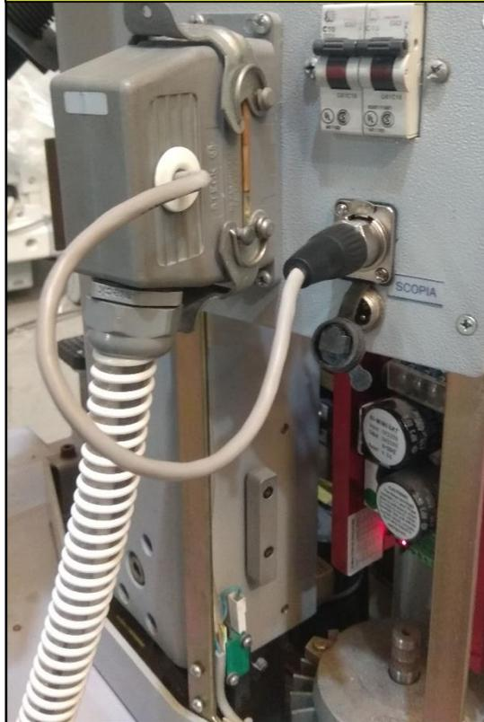
**Paso 3: Realice las conexiones del CPU y contacte con la asistencia online para instalar y configurar el software con su equipo.**
